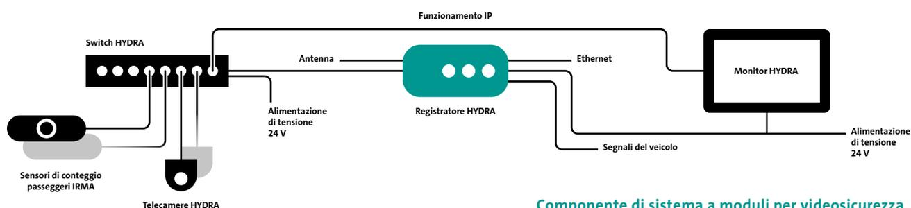
Componente di sistema a moduli per videosicurezza
